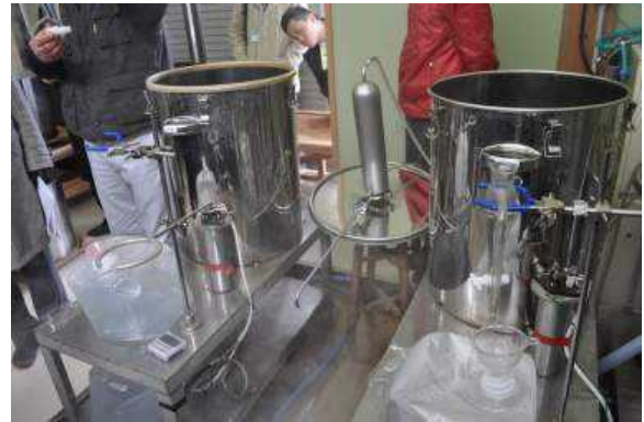
(写真3) アロマオイル抽出に用いる装置
